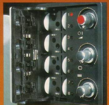
Hinter der Tasten-Klappe befinden sich die Einsteller für die Programmspeicher.
