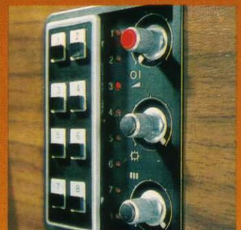
LED-Anzeige zur Programm- und Einschaltkontrolle.
