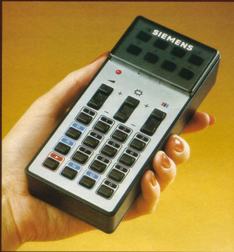
Infrarot-Fernbedienung für alle Gerätefunktionen und zum Eingeben Ihrer Programmtermine in den Mikrocomputer.
