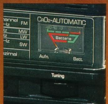
Instrument für manuelle Aufnahmeaussteuerung bzw. Batteriekontrolle.
