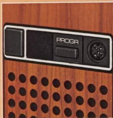
Funktionell in einer Reihe angeordnet präsentieren sich Netzaste, Mikrophon zum Empfangen der Fernsteuerungs-Impulse, Programmtaste für sequentiellen Abruf der gespeicherten Programme und Kopfhörer-Schaltbuchse.
