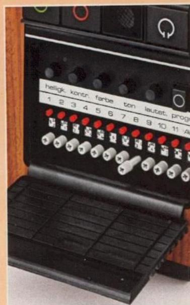
Die Bedienung des PALcolor DC 886 supersonic erfolgt in erster Linie mit der Fernsteuerung „supersonic 3000“. Die Bedienelemente für die Grundeinstellung befinden sich verdeckt hinter einer Blende.
