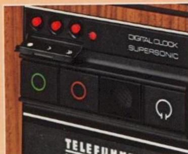
Nach einem Stromausfall oder wenn der PALcolor DC 886 supersonic mal vom Netz getrennt war, muß die Uhrzeit neu eingestellt werden. Doch keine Sorge, mit den 3 Tasten für schnellen Ziffern-Vorlauf, langsamen Ziffern-Vorlauf und Ziffern-Stop geht das ganz einfach.
