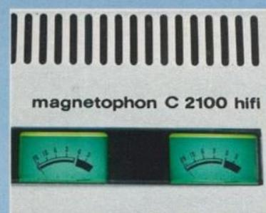
Die beiden geeichten und beleuchteten Aussteuerungs-Instrumente sind nicht nur bei Aufnahme, sondern auch bei Wiedergabe in Funktion.
