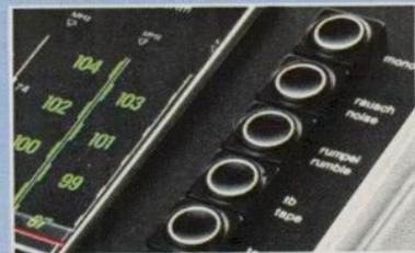
Bei oft gespielten Schallplatten und stark verrauschten Stereosendungen sorgt der Rauschfilter für einen immer noch guten Höreindruck. Wie die Bezeichnung „Rumpelfilter“ bereits sagt, werden Laufgeräusche älterer Plattenspieler, die sich durch unangenehmes „Rumpeln“ bemerkbar machen, weggefiltert.
