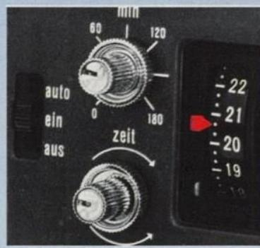
Logisch angeordnet: Der Schalter für die Wahl der verschiedenen Betriebsarten sowie die Drehregler zum Einstellen der Einschlaf-Automatik und für die Korrektur der Uhrzeit bzw. Programmierung der Weckzeit.
