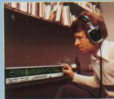
Der hymnus hifi 6040 hat zwei übersichtlich an der Frontseite angeordnete Kopfhörerbuchsen. Davon kann eine sowohl auf Kopfhörer- und Lautsprecherbetrieb als auch nur auf Kopfhörerbetrieb eingeschaltet werden. Die Schaltung geschieht dadurch, daß der Stecker um 180° gedreht in die Buchse eingeführt wird.
