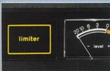
Der Limiter verbindet die Vorteile der manuellen Aussteuerung mit den Vorzügen der Aussteuerungs-Automatik. Mit den beiden Flachbahnreglern für Aufnahme links und Aufnahme rechts bestimmen Sie den Punkt, bei dem die Limiter-Funktion beginnt, d. h. Sie stellen wie bei der manuellen Aussteuerung üblich, die Regler nach den lautesten Impulsen ein.
