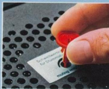
**Einstellbare Stillabstimmung.** Durch ein Potentiometer an der Unterseite des concerto hifi 4530 kann das Rauschen zwischen den UKW-Sendern individuell eingestellt werden. Diese Einstellung hat selbstverständlich keinen Einfluß auf die Eingangsempfindlichkeit des UKW-Teils. Wenn Sie auch schwach einfallende Sender empfangen wollen, muß die UKW-Stillabstimm-Automatik entsprechend eingestellt werden (Ihr Fachhändler macht das gerne für Sie).
