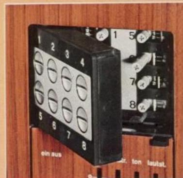
Das Sensor-Kontaktfeld der Geräte FS 230 LS, FE 260 LS und FE 270 LS springt durch Drücken der darunterliegenden kleinen Taste auf. Jetzt können Sie die Regler zur leichteren Einstellung etwas herausziehen und die einzelnen Sender vorprogrammieren. Nach dem Schließen der Klappe ist die Feinabstimmung dauerhaft gegen unbeabsichtigtes Verstellen geschützt.
