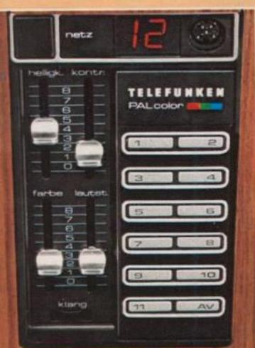
Vollelektronische Sensor-Programmwahl — das ist der „Zauberbegriff“ für höchsten Bedienungskomfort am Gerät. Denn kaum, daß Sie eine der Kontaktzonen berührt haben, ist auch schon das Programm gewechselt. Gleichzeitig leuchtet zur Kontrolle die jeweilige Programmziffer auf.
