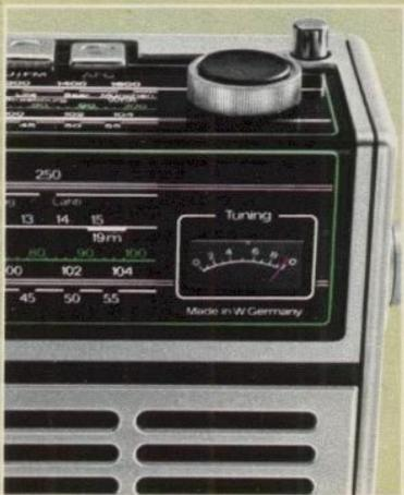
Das Abstimm-Anzeige-Instrument erleichtert eine genaue Einstellung des gewünschten Senders. Dabei entspricht der größte Ausschlag des Instrumentes einer optimalen Sendereinstellung.
