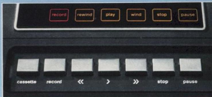
Die digitale Laufwerksteuerung mit elektronischen Tipptasten und die elektronische Bandend- und Störfassung mit Stoppschaltung sind besonders bemerkenswerte Eigenschaften des MC 3300 hifi.
