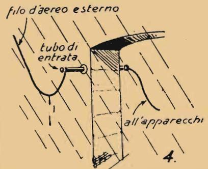
Fig. 4 - Un espediente per evitare che l'acqua piovana causi un difetto di isolamento nel tubo isolatore, che permette l'ingresso della discesa d'aereo nell'interno dell'abitazione.
