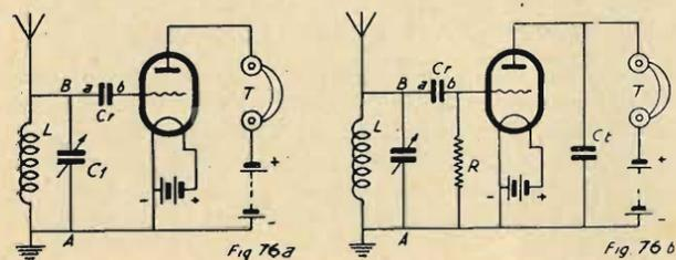
Per la ricezione telefonica occorre, quindi, ridurre le correnti ad alta frequenza, come sono ricevute nel circuito d'antenna, in correnti a frequenza minore, tali, cioè, da poter azionare il telefono. Una parte del circuito di un apparecchio radio-ricevente è, dunque, destinato a questo scopo, e prende il nome di *circuito rivelatore* o *detectore*. Nel caso di un apparecchio a valvole, la valvola che fa parte del circuito rivelatore si chiama *valvola rivelatrice* o *detectrice*.
