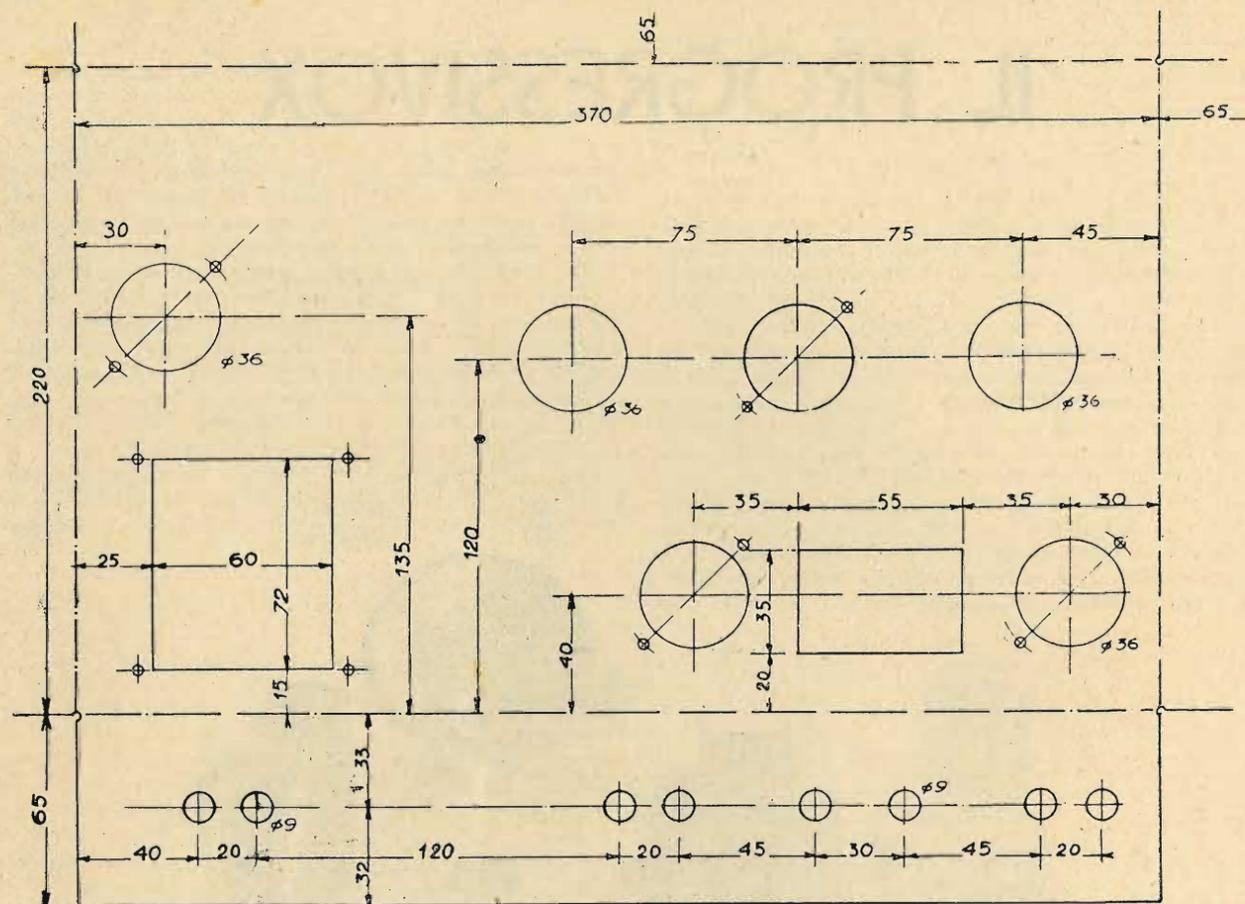
Schema di foratura dello chassis del Progressivox
