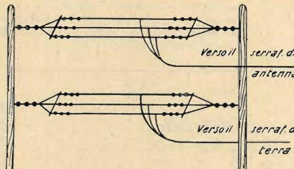
armatura del condensatore è di mettere un'altra antenna: questa seconda antenna prende il nome di contrappeso.
