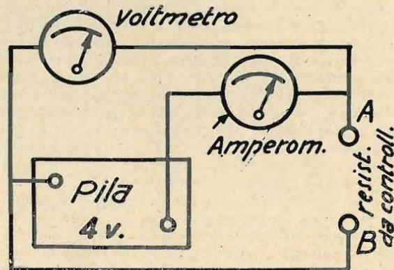
Si porranno i tre strumenti come dimostra chiaramente la figura; appena intercalata la resistenza R fra A e B, l'ago dell'amperometro devierà indicando per es. 0,14 amp. e dall'altra parte il voltmetro indicherà la f. e. m. della sorgente d'alimentazione usata, cioè, nel caso nostro 4,2 Volta: la resistenza R sarà dunque uguale
