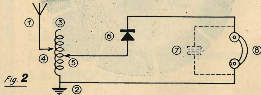
nia del circuito dell'antenna, mentre il morsetto per la terra è collegato all'ultima estremità dell'avvolgimento della bobina e contemporaneamente al secondo morsetto della cuffia telefonica. Lo schema elettrico a figura 2 darà un'idea chiara circa il funzionamento dell'apparecchio e aiuterà pure alla sua costruzione. Nel circuito dell'antenna, (1) significa l'antenna, (2) la presa di terra,
