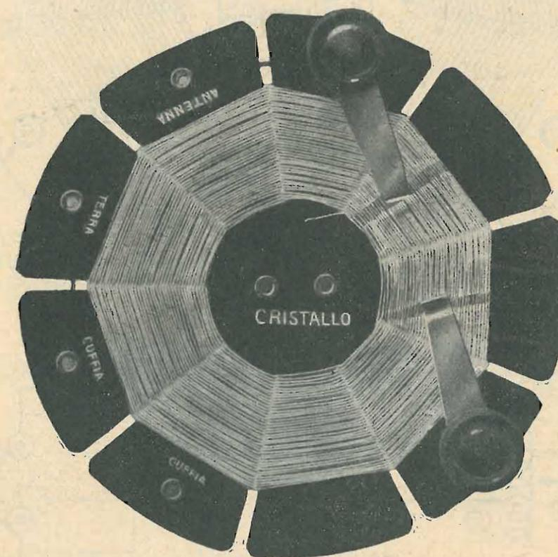
bobina di sintonia, che è del tipo cosiddetto a fondo di panier.
