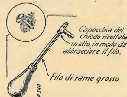
rame, il quale deve essere solidamente fermato entro l'anello stesso, il collegamento viene assicurato stringendo il tutto energicamente tra le pinze, ed eseguendo una piccola fasciatura con del filo sottile di rame.
