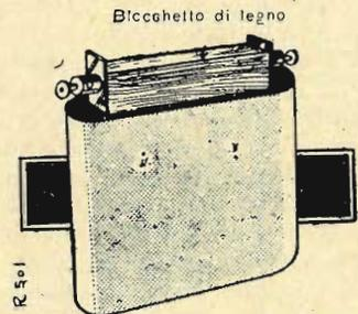
Dovendo fissare i morsetti a molte pilette, che servono a formare una intera batteria, si prende una striscia di legno, spessa circa un centimetro, larga quanto è la distanza tra le due laminette, e lunga tanti centimetri quante sono le pilette cui debbono essere applicati i morsetti. La striscia vien poi tagliata, con tagli distanti un centimetro l'un dall'altro, in modo da ottenere tanti blocchetti della forma sopra descritta quante sono le pilette.
