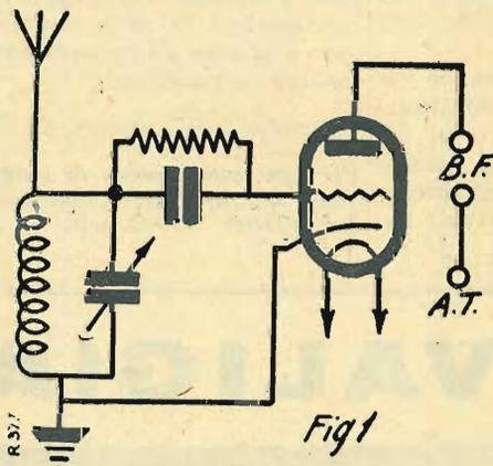
studio ed esperimento, occupa, per ciascuna stazione trasmittente, una determinata banda di frequenza; accordare un ricevitore su una data trasmissione vuol dire regolare la frequenza d'oscillazione del circuito d'accordo del ricevitore su quella della trasmittente cercata.
