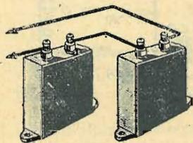
Quando l'isolante è tale da assicurare il perfetto isolamento delle piastre, un condensatore costituisce un'effettiva barriera al passaggio delle correnti continue, mentre permette il passaggio delle correnti alternate.
