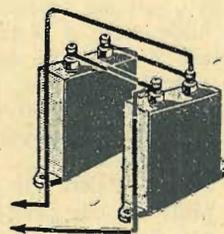
condensatore di .0005 mfd. un secondo condensatore pure da 0,0005 mfd., giacché col montaggio in *serie* di due condensatori dello stesso valore, si ottiene una capacità che è esattamente la metà del valore di quell'uno di ciascuno di essi.
