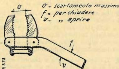
Per costruire il manico sarà bene servirsi di un tubo di acciaio, con una fessura ad una estremità, per farvi passare le due ganasce. Usato un siffatto tubo si avrà una chiave solida e capace di resistere ai più energici sforzi.
