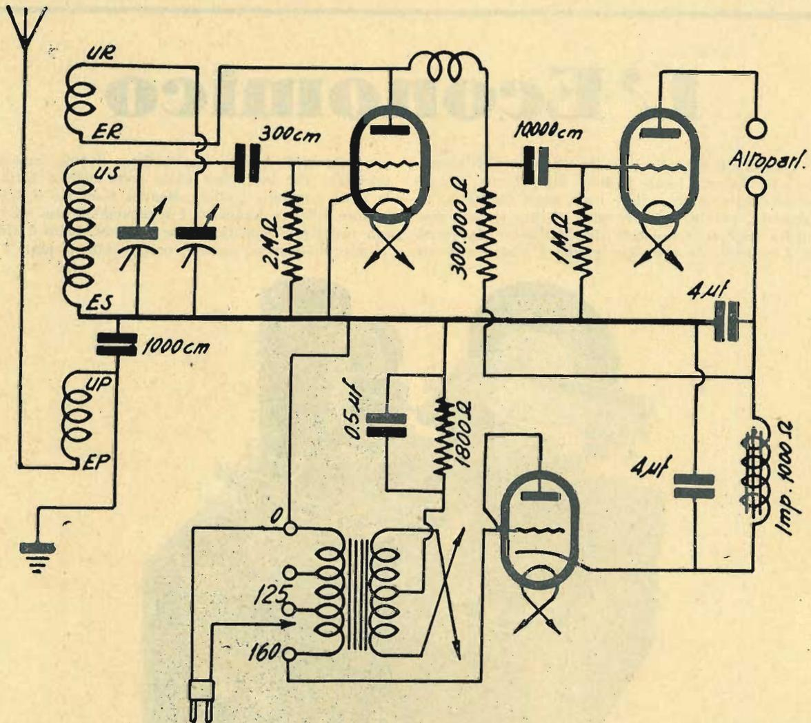
nith U 415, Tungram L 414, Sator E 4, Telefunken RE 134 e similari, sono le valvole che più si adattano allo scopo. La resistenza di polarizzazione, che noi abbiamo marcato 1000 Ohm, si riferisce alla Tungram L 414; essa dovrà variare di valore a seconda della valvola finale usata.
