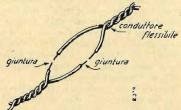
Con questo sistema e se si ha l'accortezza di denudare le due estremità dei conduttori, il rigonfio formato del nastro isolante sarà necessariamente di molto ridotto.
