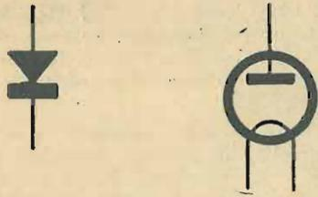
ha il predominio di un'alternanza sull'altra. Il sistema raddrizzatore lascia, per es., passare la corrente 500 o 1000 volte più facilmente in un senso che nell'altro. Gli effetti prodotti sono, dunque, superiori, e tutto avviene — a parte il rendimento inferiore — come se il raddrizzamento fosse perfetto.
