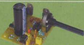
μP 88 : Alimentation haute fréquence pour éclairages de convois
