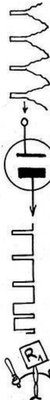
signal vidéo appliqué à la cathode demeurent inférieures à la différence de potentiel  $e$ , c'est-à-dire pendant la durée des tops de synchronisme où ces tensions sont nulles, l'anode reste positive par rapport à la cathode et le courant passe dans la diode. Mais en dehors de ces courts instants, la tension positive appliquée à la cathode est supérieure à  $e$  et rend ainsi l'anode négative par rapport à la cathode. Dès lors, la diode est bloquée, c'est-à-dire ne laisse passer aucun courant.
