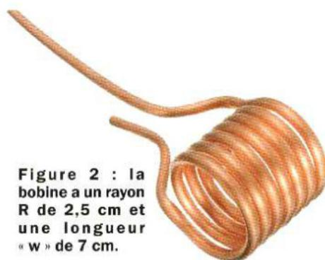
**Figure 2 : la bobine a un rayon R de 2,5 cm et une longueur « w » de 7 cm.**
