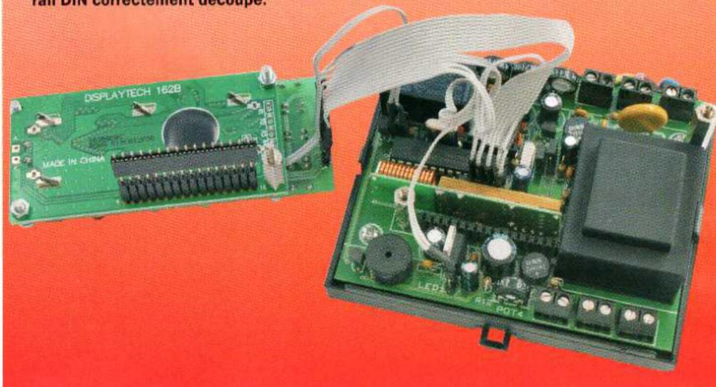
Dans ce cas, il est nécessaire de porter la broche G0 de U3 à 5 V, cela double le gain du PGA interne (G = 16).
