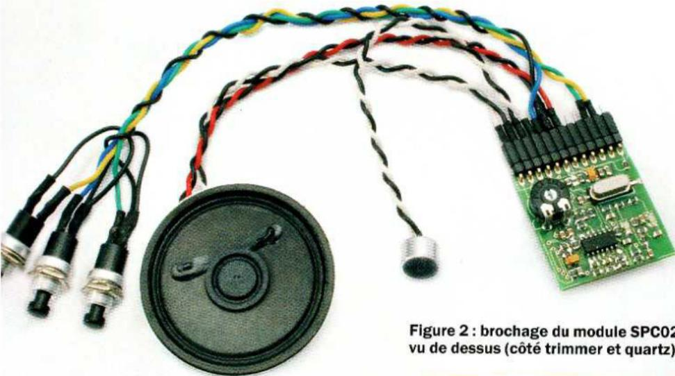
Figure 2 : brochage du module SPC02 vu de dessus (côté trimmer et quartz).
