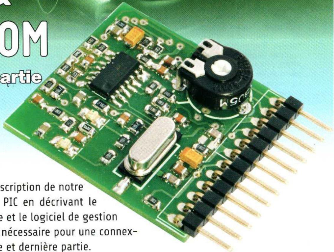
Nous terminons la description de notre enregistreur vocal à PIC en décrivant le module le plus simple et le logiciel de gestion avec l'interface série nécessaire pour une connexion à un PC. Troisième et dernière partie.
