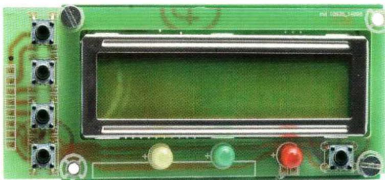
Photo de l'un de nos prototypes de la carte afficheur.
