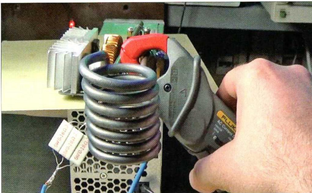
Figure 9 : la pince ampèremétrique permet de vérifier le courant absorbé par le circuit.
