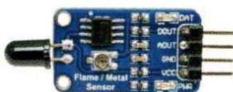
Photo de l'un de nos prototypes du détecteur de flamme.
