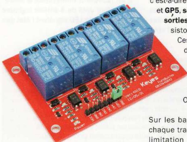
**Figure 1** : ici la carte relais permettant de commuter des charges électriques en continu ou en alternatif.
