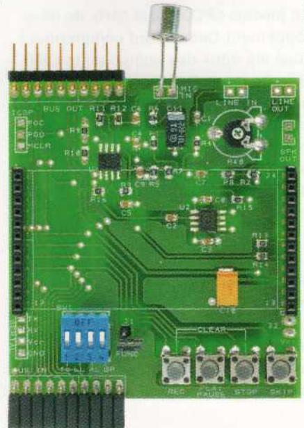
Photo de l'un de nos prototypes de la carte de développement pour le module SPC01.
