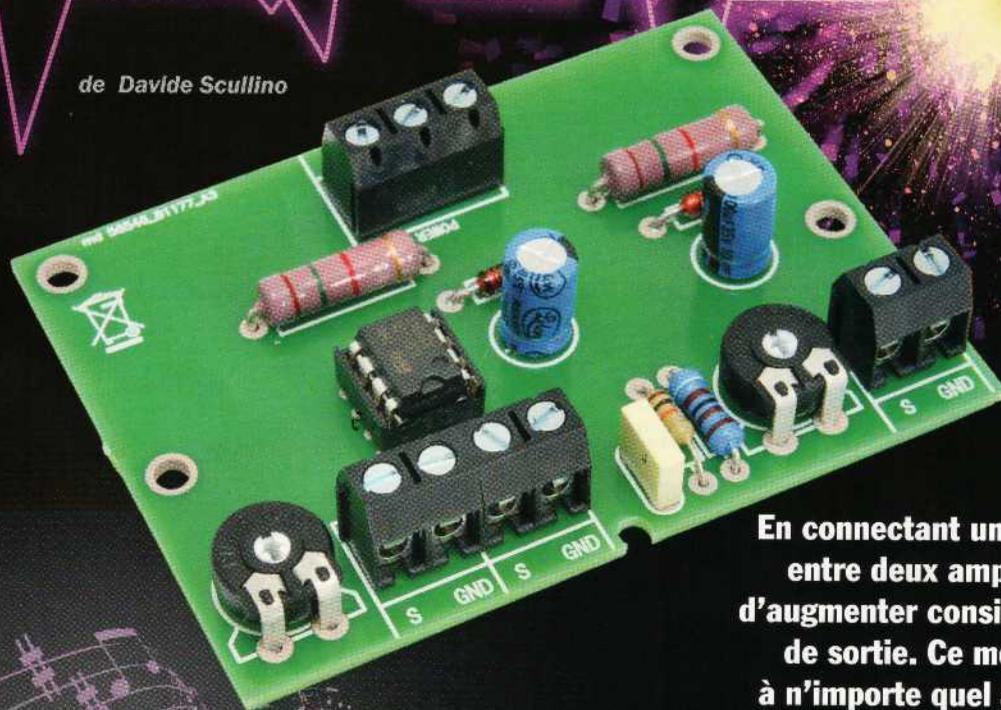
**En connectant un simple circuit déphaseur entre deux amplificateurs, il est possible d'augmenter considérablement la puissance de sortie. Ce montage peut être appliqué à n'importe quel amplificateur audio, donc aussi à l'amplificateur MOSFET 200 W décrit dans ce même numéro.**
