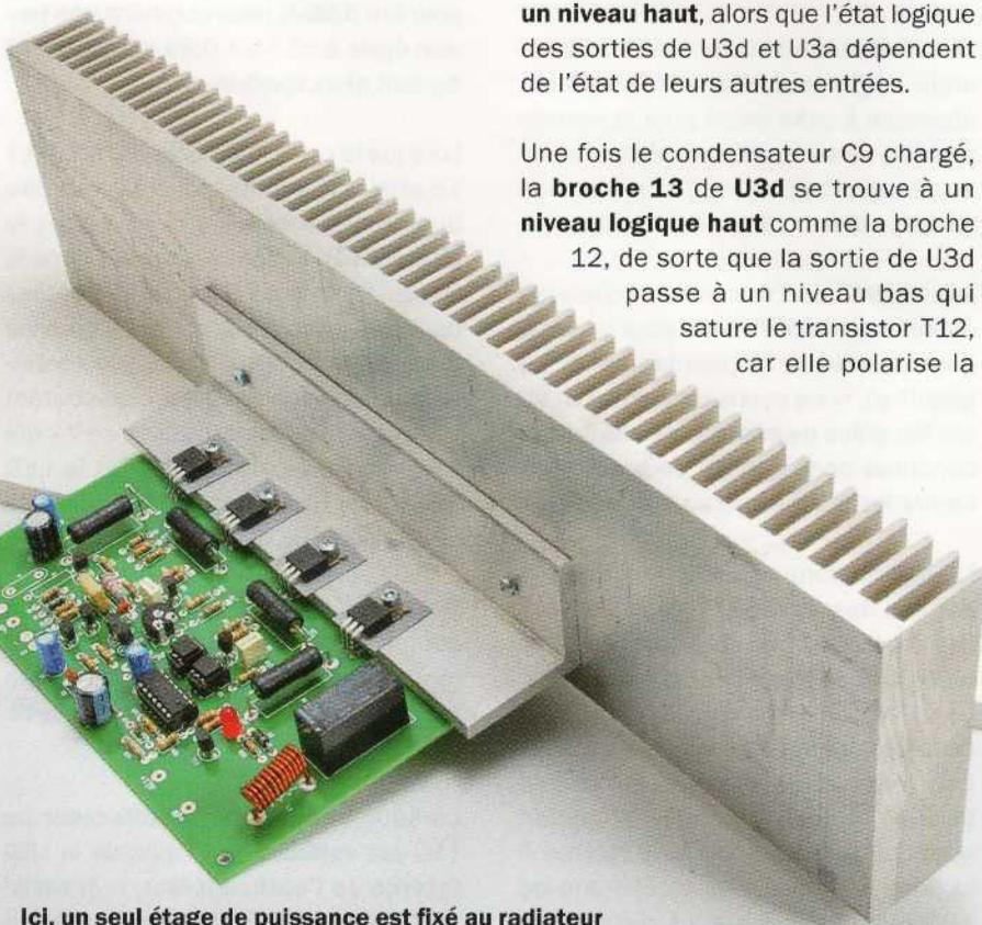
Ici, un seul étage de puissance est fixé au radiateur à l'aide d'une équerre en aluminium.
