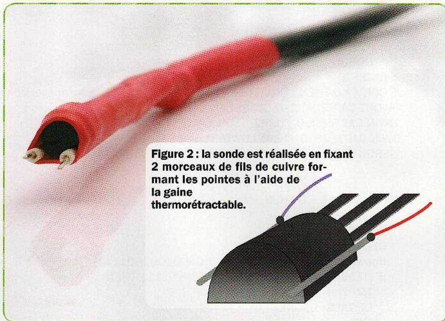
Figure 2 : la sonde est réalisée en fixant 2 morceaux de fils de cuivre formant les pointes à l'aide de la gaine thermorétractable.
