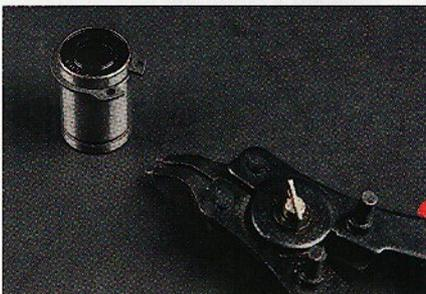
Figure 9 : installez les circlips avec la pince adéquate, vous devez avoir 2 circlips sur chaque roulement.
