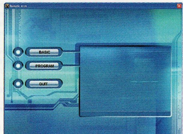
Figure 4 : avec le bouton « **BASIC** » vous entrez en mode de commande manuelle et avec le bouton « **PROGRAM** » vous accédez à la création de séquences de commandes.
