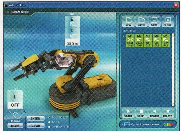
Figure 6 : construction de la séquence des mouvements du bras robotisé.
