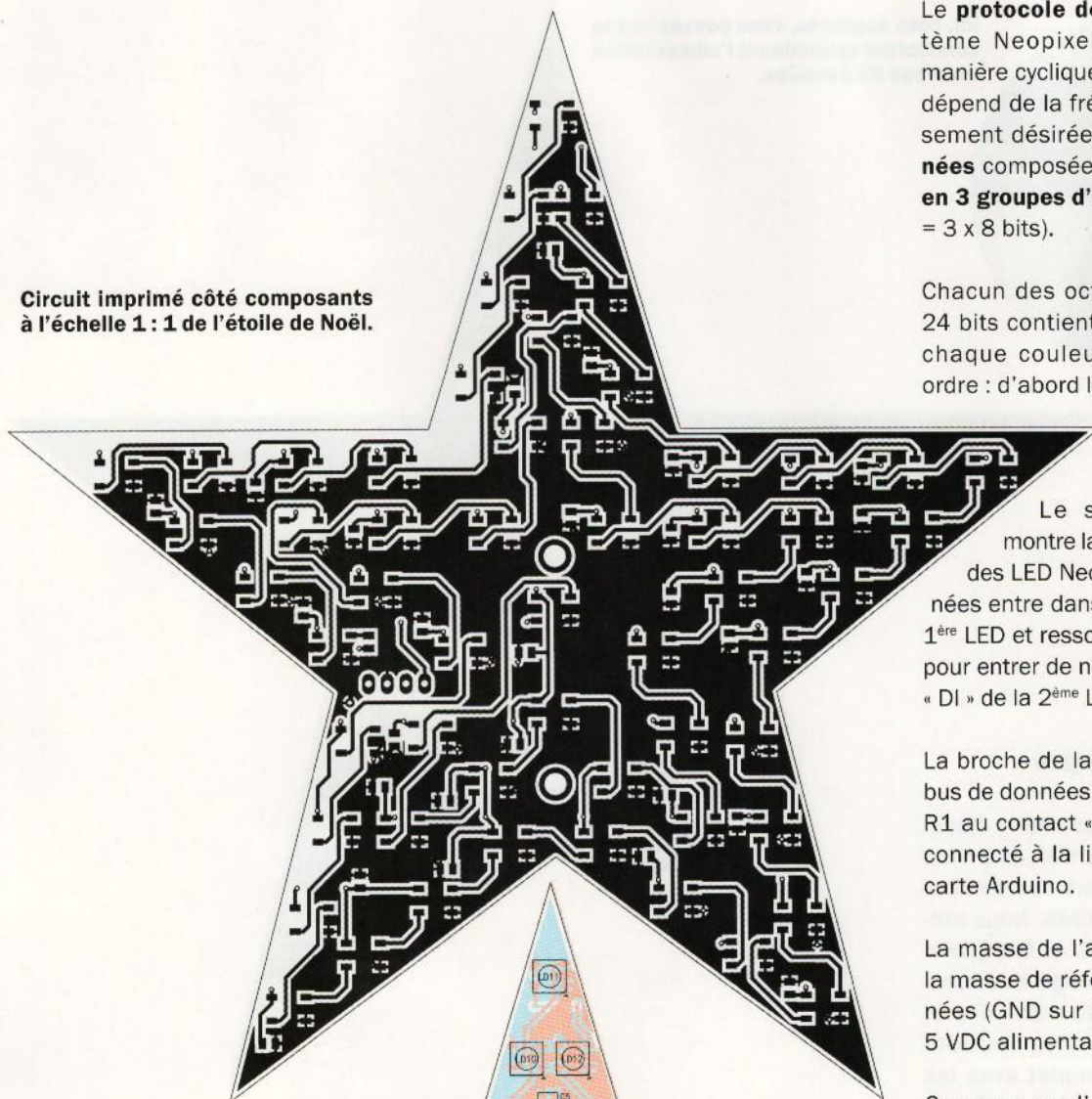
Plan de câblage des composants de l'étoile de Noël.
