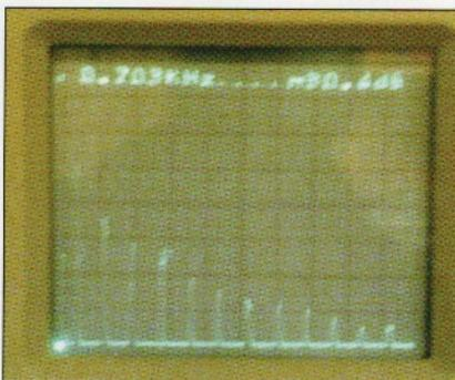
**Figure 22 :** spectre d'un signal carré à 100 Hz. L'échelle est en dB et le curseur pointe vers la 3<sup>ème</sup> harmonique (700 Hz). La fréquence d'échantillonnage est fixée à 4,88 ks/s pour acquérir correctement toutes les harmoniques du signal.
