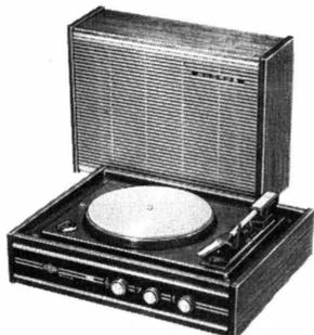
**Réf. EC 10** - Electrophone mono, platine 33, 45, 78 tr/mn, cellule crist. saphir révers. 33-45/78 tr, ampli 4 watts, volume, tonalité séparée Gr./Aig., prises magnéto et entrée tuner, alim. 110/220 V, H.P. dans couvercle dégonflable, dim. fermé : 392 x 315 x 278 mm.
