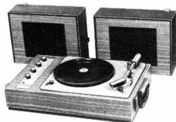
**Réf. EC 30** - Electrophone stéréo portable, platine 33 - 45 tr/mn, cellule cristal, lève/repose-bras, ampli 2 x 7 watts, volume, tonalité séparée Gr./Aig., balance, alim. 110/220 V - H.P. dans couvercle 2 parties, dim. fermé 440 x 290 x 190 mm.
