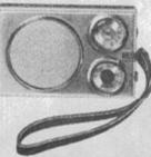
**Réf. RC 30** - Radio-réveil PO-GO, Puiss. 150 mW, 7 transistors, 2 diodes, alim. pile 9 V., mise en marche automat. à l'heure choisie, dim. 129 x 85 x 36 mm - Avec dragonne, housse cuir et écouteur d'oreille
