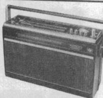
**Réf. RC 65** - Récept. FM avec C.A.F.) GO-PO-6 OC (2 à 5 - 5 à 7,4 - 9,5 à 9,8 - 11,7 à 12,1 - 15,1 à 17,9 - 21,4 à 21,8 MHz), vu-mètre de champ, puiss. 1 W, tonal. Gr./Aig., alim. 6 piles 1,5 V, prise pour alim. externe, prises magnéto, écouteur, HP suppl., dim. 365 x 250 x 105 mm.
