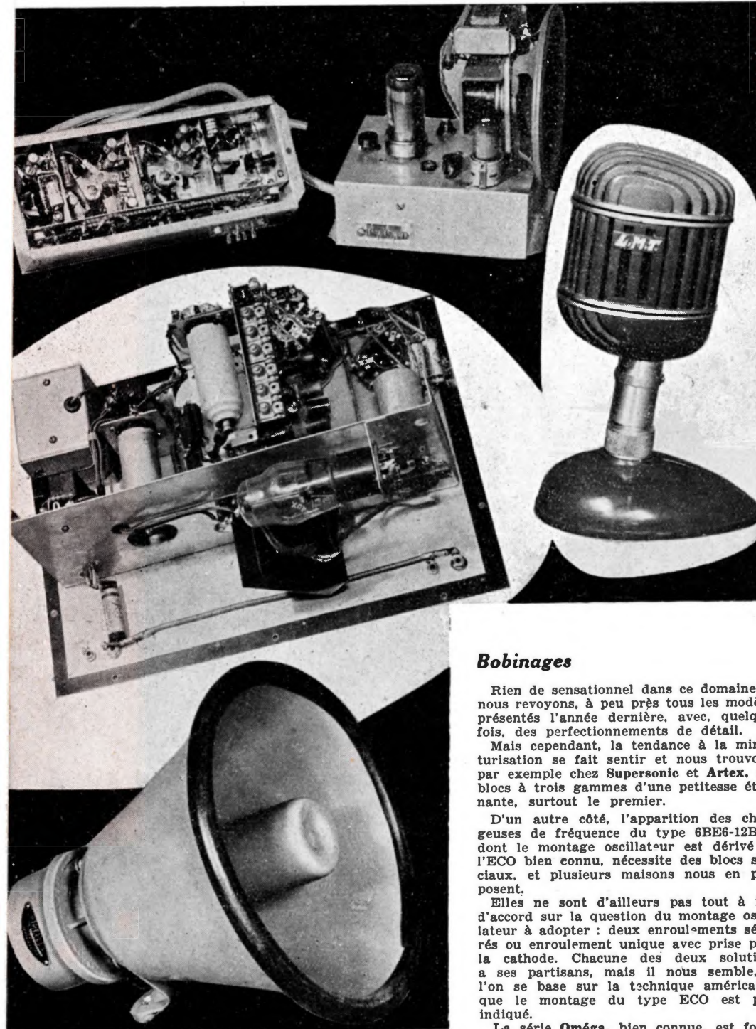
De haut en bas et de gauche à droite — Bloc de télévision Ducastel, à gauche bloc récepteur « image », à droite, bloc récepteur « son ». — Intérieur du nouveau générateur H.F. Audiola. — Microphone cardioïde L.M.T. — H.P. Babyflex Bouyer de 25 cm de diamètre à chambre de compression.
