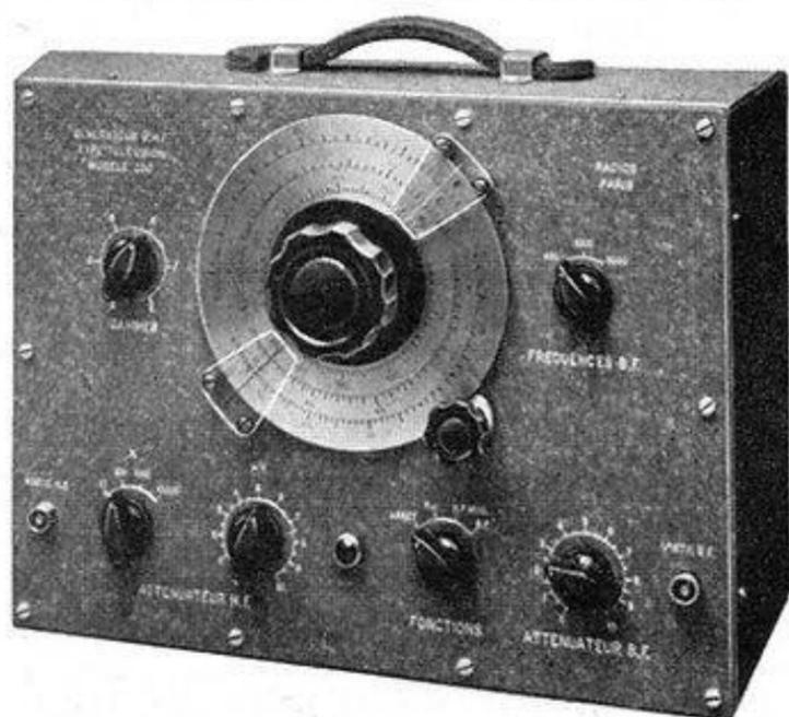
Six gammes (22 à 216 MHz) en fondamentales ● 3 fréquences de modulation B.F. à profondeur réglable ● Sortie B.F. sur atténuateur séparé ● Sortie H.F. sur atténuateur double, à décades et progressif, efficace depuis 0,1 volt jusqu'à moins de 10  $\mu$ V ● Sorties par fiches et câbles coaxiaux adaptés ● Doubles blindages, fuites négligeables.
