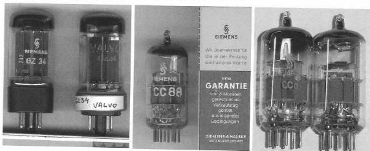
**Figure 50.** À gauche, deux valves GZ34. La Siemens qui porte le code f33 – L1i a été fabriquée en 1971 par MBLÉ à Bruxelles, et labellée par Siemens en mars 74. Les GZ34 Siemens et Telefunken proviennent toutes de la MBLÉ. La Valvo à embase métal est vraiment allemande, faite à Hambourg en 1954, code
