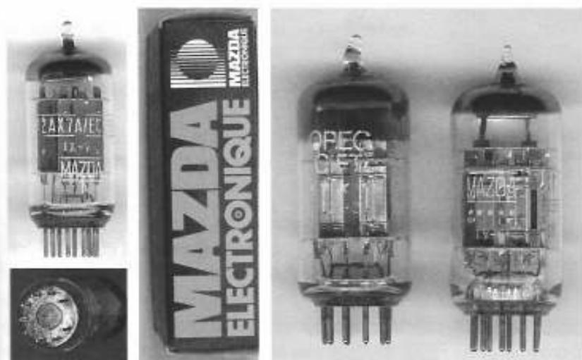
**Figure 40.** On trouve de magnifiques Mazda ECC83, comme cette vraie... Telefunken (!) de 1967 relabellée ci-dessus, à plaques lisses, embase bleutée et carré gravé entre les broches (voir plus loin les signes distinctifs des tubes Telefunken), ou ces deux
