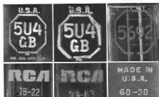
**Figure 61.** Les coupures dans l'octogone du logo RCA indiquent la date de fabrication. Les coupures aux coins ou très près des coins donnent le dernier chiffre de l'année, en partant de zéro en haut, et en tournant dans le sens horaire, voir schéma ci-dessus à gauche.
