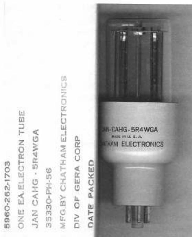
**Figure 89.** Encore fabriquée jusqu'à une date récente, probablement 1995, la valve 5R4 peut redresser 900 V et fournir 150 mA. Elle est idéale pour les amplis monotriodes, en particulier ceux à base de triode 845, qui demandent 1200 VDC et 90 mA. L'embase est en Micanol haute tension, le bulbe très épais supporte un vide très poussé et est collé au silicone à l'embase. La structure interne est celle de la 5U4GB, avec deux colonnes supports supplémentaires.
