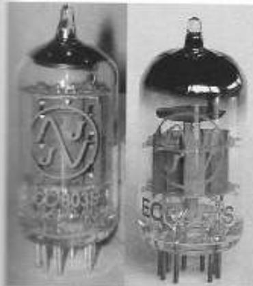
**Figure 17.** Tubes JJ. Ci-dessus à gauche deux versions de ECC83 : la 803S à plaques longues, à gauche et la 83S à plaques courtes, à droite. Cette dernière utilise une grille-cadre et un écran de getter. Ci-contre à droite la très appréciée KT88.
