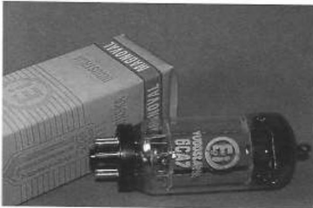
**Figure 18.** Un tube EL34 / 6CA7 yougoslave de 1990, fabriqué par EI à Nis en Serbie. La boîte est fortement inspirée des graphismes Philips car l'usine appartient au groupe hollandais. (La mention *magnoval* est erronée). On remarque le queusot situé sur le dessus du tube, ainsi que l'embase courte et le getter double en anneau.
