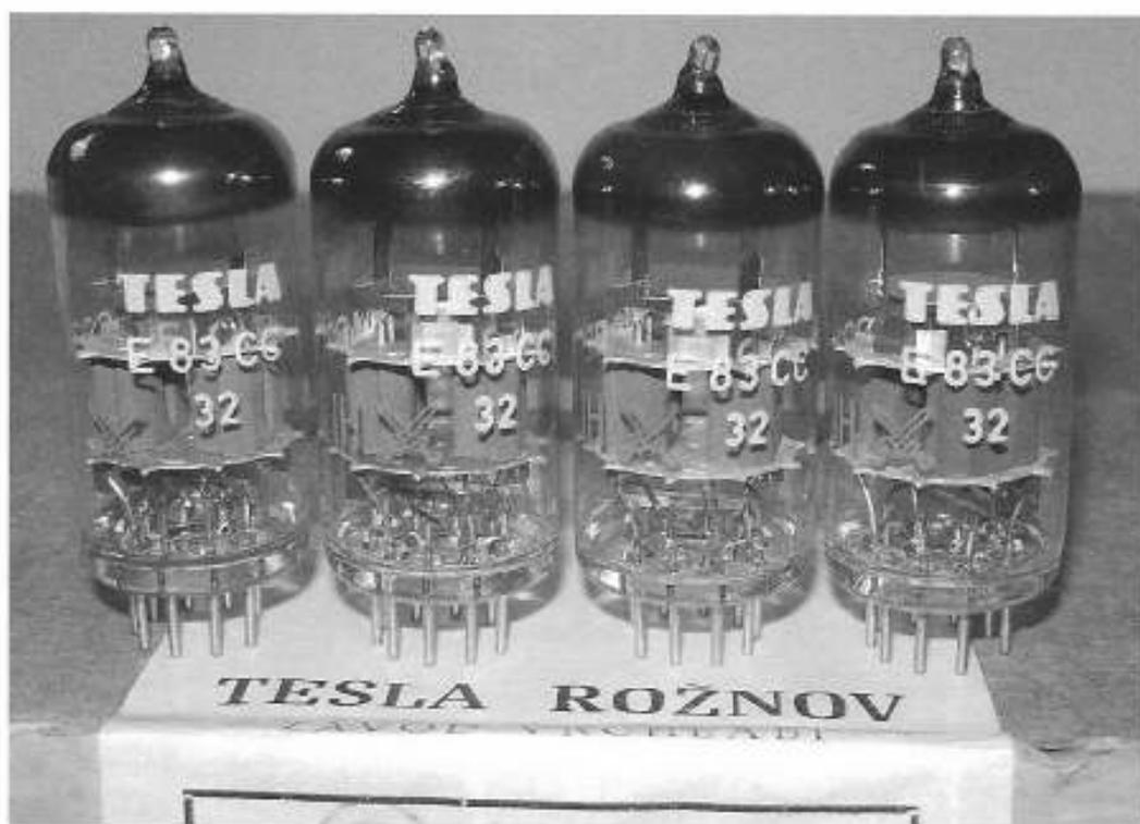
**Figure 51.** Les sabres croisés, emblèmes de la Czech-Post, figurent sur ces E83CC construites sur le modèle Telefunken ECC803S. Écran de getter, grille-cadre dorée, broches en rhodium, filament à double isolation, triodes appairées à faible bruit et durée de vie de 10000 heures, tout cela pour un prix dix fois inférieur aux Telefunken ECC803S !
