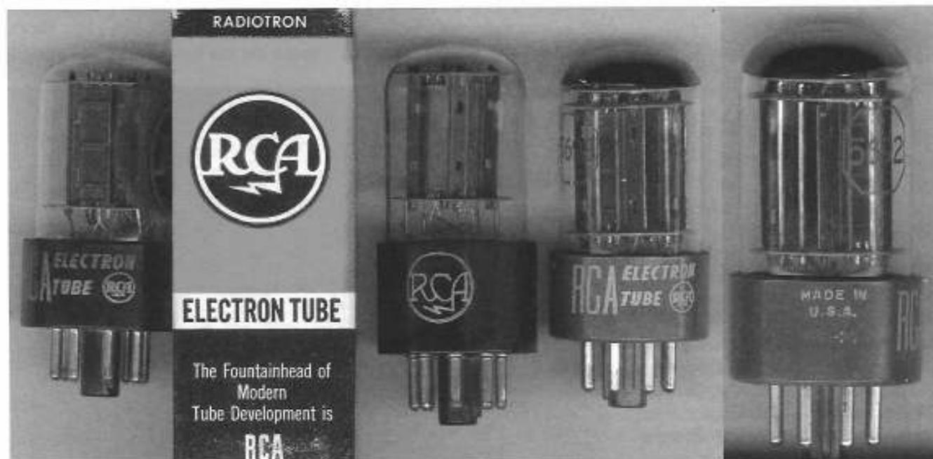
**Figure 57.** Dans la série octal (standard de support inventé par la marque) RCA a produit d'excellents tubes, comme la 6SN7GT des années 50 à gauche, avec plaques nervurées en échelle, noires mates, et getter latéral (ici un modèle 56).
