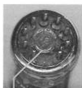
Au centre du socle, entre les broches, sont gravés le signe <math>\leftrightarrow</math> propre aux tubes Telefunken, et parfois un code chiffré, ici 18/1
