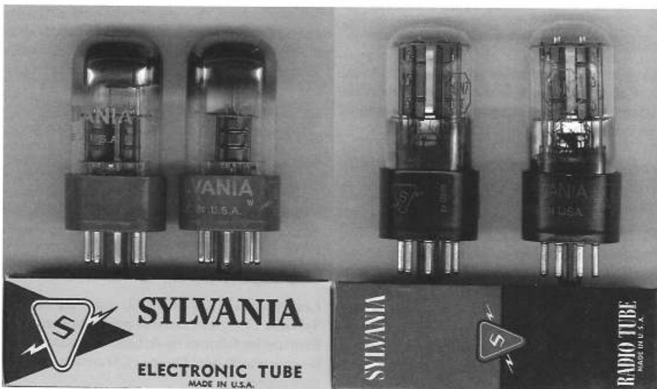
**Figure 71.** À gauche une paire de 6SL7-WGT à plaques noires cylindriques courtes, getter en D en haut. Le label est soit jaune sur le bulbe, soit gris sur l'embase, pour ces tubes pourtant sortis d'un même lot, daté de 1957. Les plus musicales de toutes les
