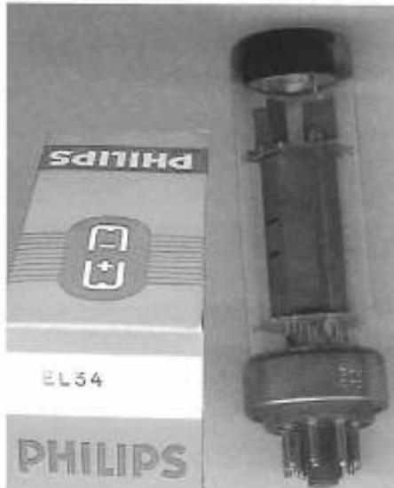
**Figure 32.** Une EL34 de 1957 fabriquée à Eindhoven. La base en métal porte le code gravé SY1-57C. Très difficiles à trouver en bon état, ces versions à base métal ont été fabriquées à partir de 1954 avec base plus haute, code SY0, puis base comme ci-dessus de 1955 à 1957. Le getter est en disque plat sur deux supports et les plaques soudées.
