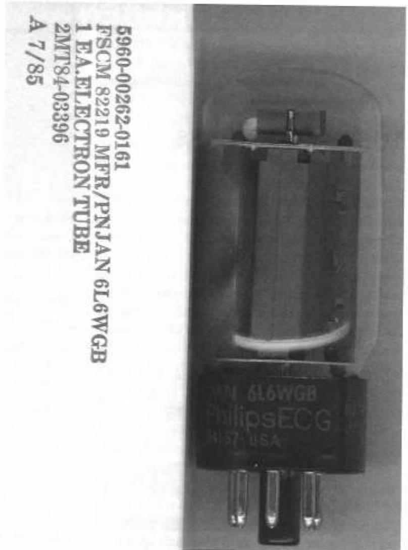
**Figure 16.** Ci-dessus tube tétrode 6L6 version B militaire américaine renforcée (W) produite par Philips en 1985 dans l'usine de ECG (ex-Sylvania). Très appréciée dans les amplis pour guitare, elle est devenue assez rare aujourd'hui.
