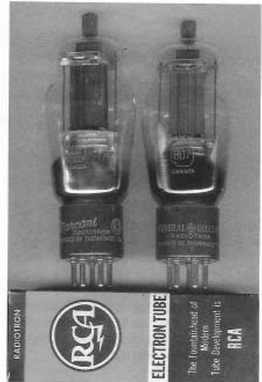
**Figure 59.** Quelques excellentes valves RCA, avec à gauche une 5V4 militaire de 1956 avec bulbe ST14, et à droite une 5U4G de l'US-Navy de juillet 1943 (code K4E) toutes deux avec getter en bas et embase en ligne. Avec les petits ressorts autour du mica supérieur et les supports de filament de type *canne à pêche*, elle ressemble étrangement à la Néotron française...
