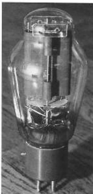
**Figure 29.** O & J produit une remarquable copie de la triode à chauffage direct 300B, créée par Western-Electric vers 1930. Les matériaux constituant le filament ont demandé de longues recherches.
