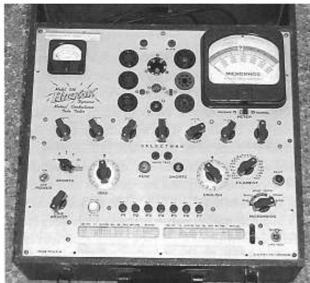
**Figure 6.** Un véritable lampemètre est du type *mutual conductance tube tester* comme ce Hickock 536 de 1957. En plus d'une mesure de pente dynamique, des tests de court-circuit, de gaz, de durée de vie, de bruit de fond (écoute au casque) et de microphonie sont possibles. Indispensable aux amateurs.
