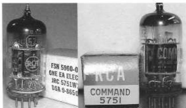
**Figure 56.** RCA a produit quelques-unes des plus fameuses versions de la 5751, avec plaques noires et supports supplémentaires. Les versions militaires JAN-CRC (ou JRC) et *Command* ci-contre datent des années 50. On peut voir au-dessus des micras supérieurs, les tiges supports repliées et prenant appui sur le mica, pour une rigidité absolue. L'usage dans les appareils de transmissions US-Navy, US-Air-Force, soumis aux chocs et vibrations, imposait cette construction imperturbable.
