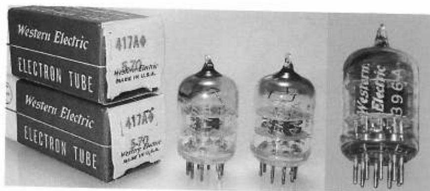
**Figure 69.** La valve préférée des amateurs d'ampli monotriode est cette WE-274B, à gauche, modèle proche de la 5U4GB. La petite triode 417A au centre, équivalente à la 5842, présente sous un format très réduit, un  $\mu$  de 43 et une pente énorme de 24 mA/V.
