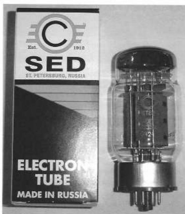
**Figure 25.** Les tubes fabriqués à St-Petersbourg par Svetlana portent le *Winged-C* logo en lettres dorées. La boîte porte également ce logo. Les getters en forme de coupelle et les ressorts de mica permettent de distinguer ces tubes des copies SVKT88 soustraitées à Ryazan ou Saratov par New-Sensor.
