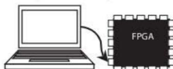
Pour les FPGA reprogrammables, afin de conserver une ou plusieurs configurations du composant à la mise hors tension du système, il convient de stocker les données de configuration dans une mémoire non volatile de type EEPROM (*Electrically Erasable Programmable Read-Only Memory* – Mémoire morte programmable et effaçable électriquement) ou Flash. Cela évite de recourir à l'utilisation d'un ordinateur après chaque coupure d'alimentation.
