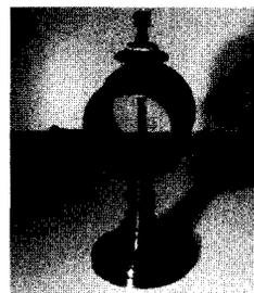
Électroscope utilisé par Branly lors de ses études sur la conduction électrique.
