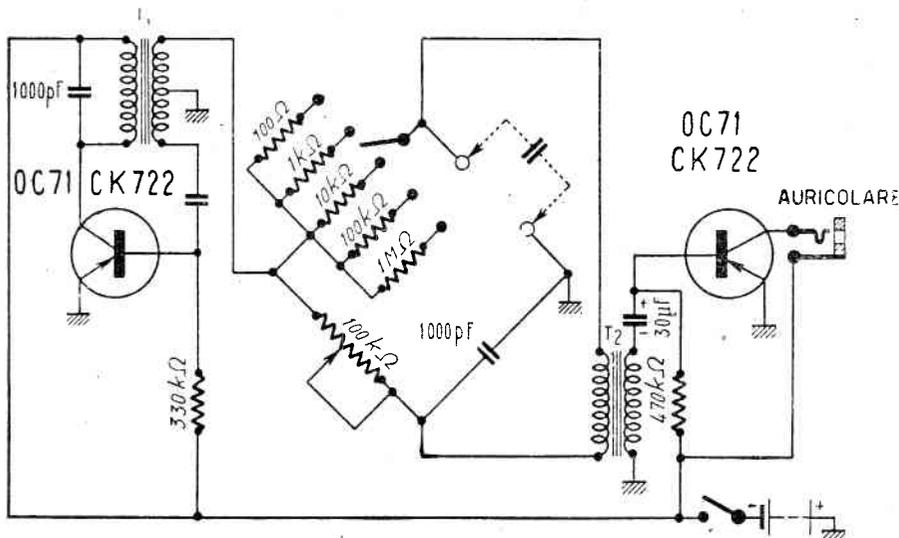
**CAPACIMETRO A PONTE CON DUE TRANSISTORI TIPO CK722 OPPURE OC71**
