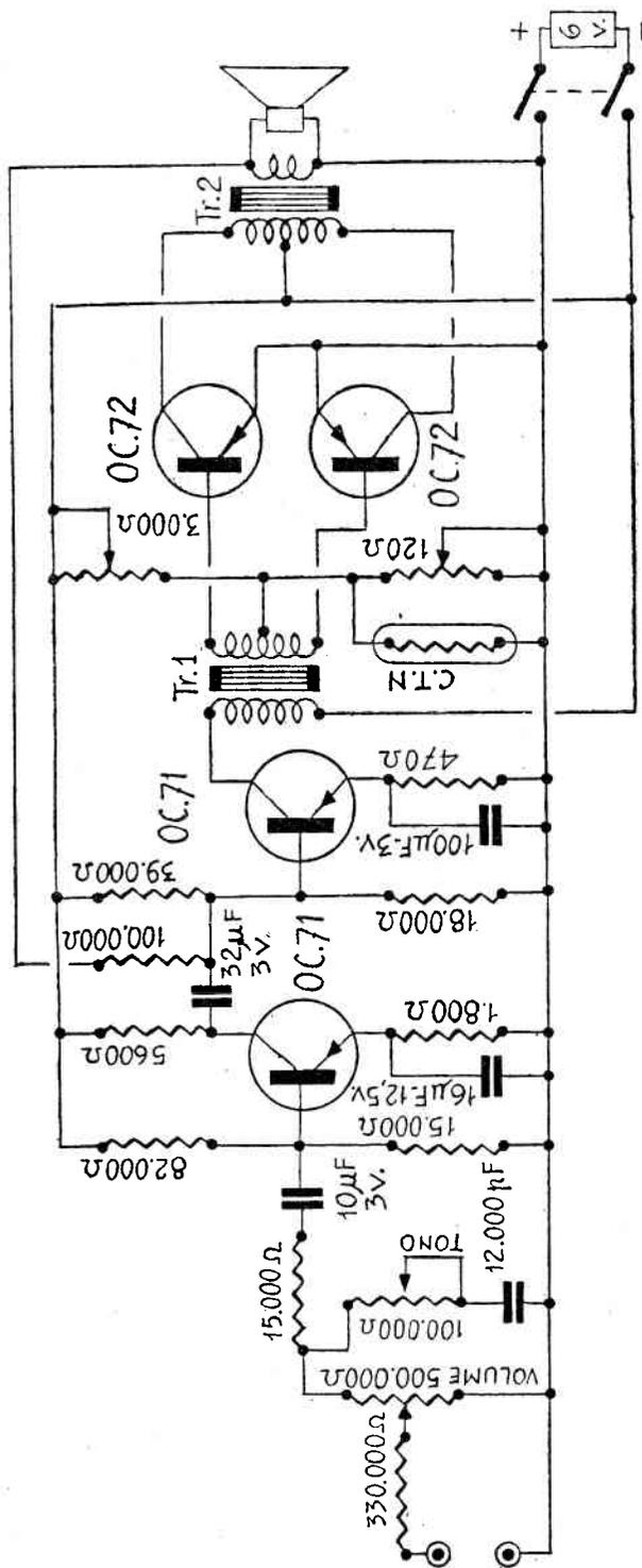
AMPLIFICATORE DELLA POTENZA DI 150 mW
