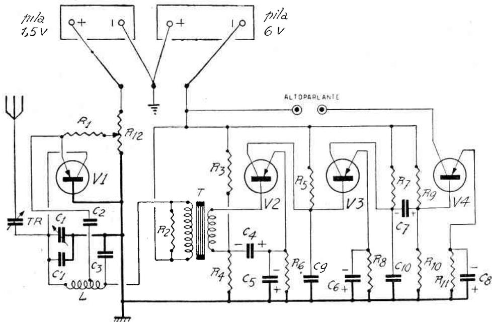
**RICEVITORE A 4 TRANSISTORI A SUPER-REAZIONE
