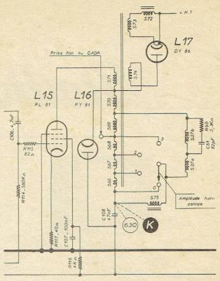
ATTENTION. — Lors du remplacement de la diode DY 86 enfoncer correctement le téton d'anode dans le clips intérieur.
