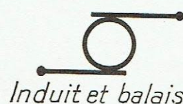
Fig. 23. — Représentation schématique adoptée pour les bobines et collecteurs dans les schémas de circuits.
