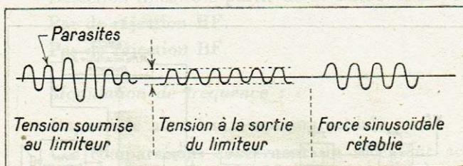
Fig. 1. — L'action du limiteur d'amplitude.
