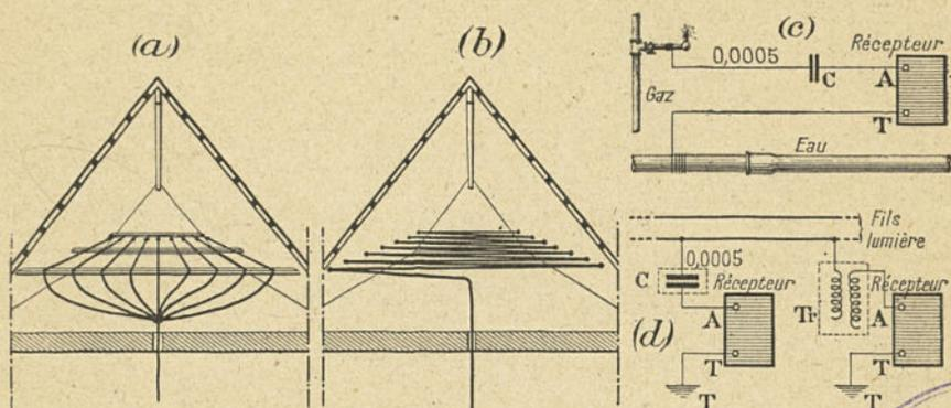
L'antenne intérieure convient spécialement aux *circuits réactifs* dont la lampe détectrice possède sa sensibilité maximum lorsque les ondes à recevoir l'impressionnent sous un très faible voltage. Avec les postes à lampes à *réaction*, l'antenne intérieure donne une réception plus nette et souvent plus forte que l'antenne extérieure dans le voisinage immédiat et jusqu'à la moitié environ de la portée normale des stations émettrices.
