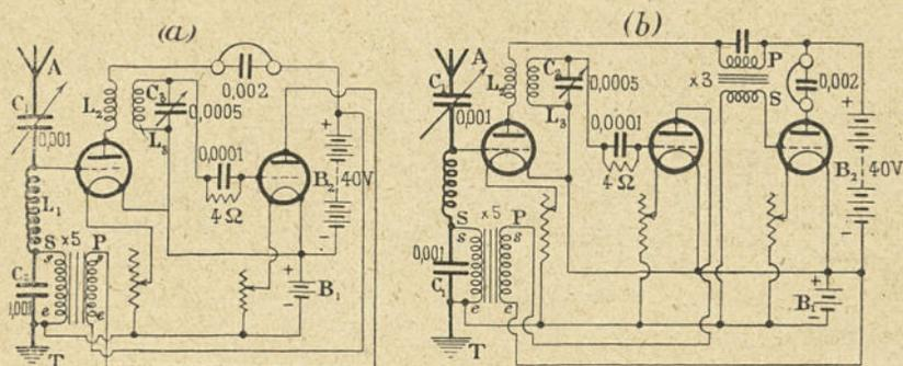
a) Circuit *Reflex* établi pour supprimer l'emploi du détecteur à cristal. La réaction s'effectue par couplage des selfs  $L_2 L_2$ , de sorte qu'elle ne fait pas rayonner l'antenne.
