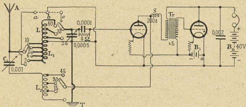
Circuit donnant une réception remarquable des ondes courtes (200 à 500 mètres), spécialement en télégraphie sans fil par ondes entretenues. La stabilité de fonctionnement du dispositif, la réduction des effets de capacité provenant du corps de l'opérateur pendant le réglage, l'énergie supplémentaire recueillie grâce à l'emploi de longues antennes aperiodiques, font du Reinartz l'un des montages préférés de l'amateur.
