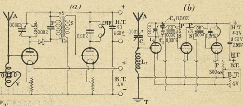
a) Montage convenant à la réception de la téléphonie sans fil sur ondes courtes (300 à 500 mètres). Le variomètre V comporte 2 fonds de panier de 40 tours. La self du circuit résonant est un nid d'abeilles de 75 tours. Le circuit ne comporte pas de réaction afin d'éviter toute possibilité de déformation des émissions radio-téléphoniques. Haut-parleur dans un rayon moyen de 150 kilomètres sur petite antenne extérieure.
