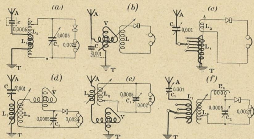
a) Circuit sélectif à primaire apériodique (*ondes de 250 à 700 mètres*). La self secondaire  $L_2$  est une bobine de 7,5 centimètres de diamètre avec 80 tours de fil 5/10 sous coton. La self  $L_1$ , de 8 tours de fil 10/10 à 2 couches coton, est enroulée conjointement autour des spires centrales de la self  $L_2$ . Le condensateur  $c$  sert de « sécurité » sur la lumière électrique.
