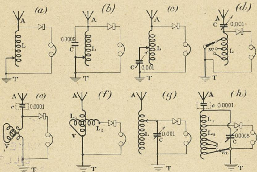
a) Circuit amorti le plus simple avec bobine à 1 curseur. Pour la réception des ondes de 200 à 2.600 mètres, enrouler 300 spires de fil émaillé 6/10 sur un tube de carton de 10 centimètres de diamètre et 25 centimètres de longueur.
