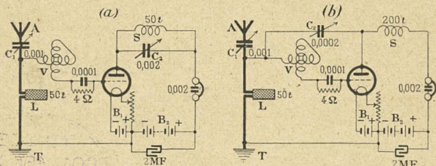
a) Circuit très sensible et très stable. La self d'antenne L est un nid d'abeilles de 50 tours. Le variomètre V comporte 2 enroulements de 50 tours 10/10 sous 2 couches coton. La self S, de 50 à 75 tours, est shuntée par un condensateur variable à 3 plaques du type vernier. Pour le réglage : accorder avec  $C_1$ , le variomètre V étant court-circuité; mettre le variomètre en circuit, retoucher  $C_1$  et régler la réaction avec  $C_2$ .
