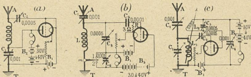
a) Circuit direct sensible, sélectif et de réglage facile. La self  $L$  est un nid d'abeilles de valeur adaptée à la gamme des longueurs d'onde que l'on désire recevoir. Les plaques mobiles des condensateurs  $C_1$  et  $C_2$  sont connectées du côté Terre pour réduire au minimum les effets de capacité produits, en cours de réglage, par la main et le corps de l'opérateur.
