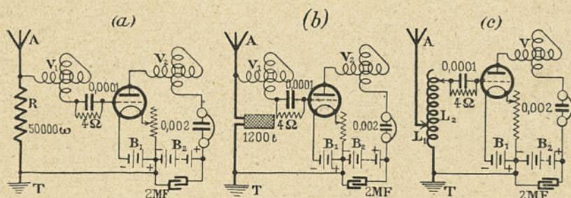
a) Circuit R. A. F. à effet régénérateur par accord variométrique de plaque. L'antenne est munie d'une résistance fixe de 50.000 ohms qui réduit l'action des parasites et facilite le réglage critique de la réaction. Le variomètre  $V_1$  comporte 2 enroulements de 30 tours (fil de 10/10 à 12/10 sous 2 couches coton); le variomètre  $V_2$  se fait avec 2 enroulements de 50 tours (fil 5/10 à 6/10 sous coton).
