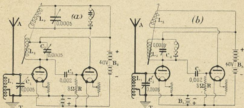
a) Montage comportant une première lampe H. F. à résonance et une deuxième lampe amplificatrice, avec détection par galène dans le circuit de plaque de la deuxième lampe. L'emploi d'un détecteur à cristal permet une grande pureté de réception et une consommation réduite de courant de chauffage. Les selfs  $L_1$ ,  $L_2$ ,  $L_3$  sont des nids d'abeilles interchangeables assortis d'après les indications du tableau suivant :
