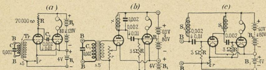
a) Circuit à 2 lampes et 1 transformateur avec liaison par résistance-capacité entre la première et la deuxième lampe. Ce circuit se monte à la suite d'un poste à galène. La tension plaque doit être élevée (80 volts au moins). Le condensateur fixe  $C_2$  aura une valeur moyenne de 0,005 M.F. La résistance  $R$  est de 70.000 à 80.000 ohms. L'amplification obtenue est d'environ 12 fois; elle est plus faible, mais plus pure qu'avec 2 transformateurs.
