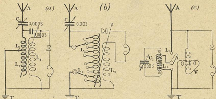
a) Circuit extra-sensible pour réception à grande distance sur antenne unifilaire de 40 mètres environ de longueur horizontale (hauteur minimum 12 mètres). La self d'antenne  $L_1$ ,  $L_2$  et la self réactive  $L_3$  sont des nids d'abeilles interchangeables accouplés, de chacun 50 tours (ondes de 300 à 600 mètres); 150 tours (1.500 à 1.800 mètres), 400 tours (2.500 à 2.800 mètres).
