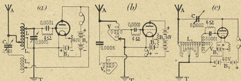
Le circuit *Reinartz* permet de recevoir les ondes courtes et moyennes sur grande antenne désaccordée. Très sensible pour les ondes courtes et d'une grande simplicité de réglage, le *Reinartz* se recommande à l'amateur qui dispose du secteur électrique ou d'un circuit téléphonique comme collecteur d'ondes.
