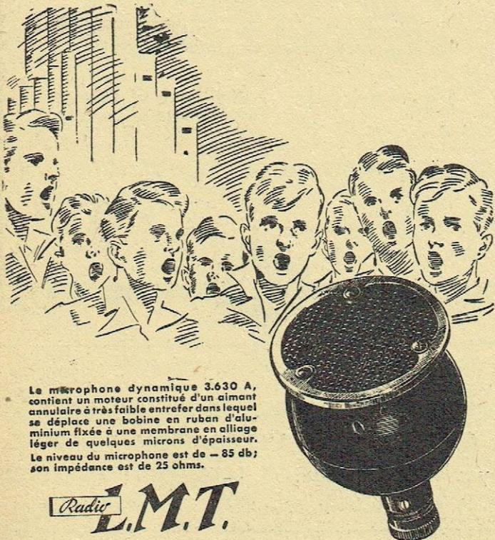
Le microphone dynamique 3.630 A, contient un moteur constitué d'un aimant annulaire à très faible entrefer dans lequel se déplace une bobine en ruban d'aluminium fixée à une membrane en alliage léger de quelques microns d'épaisseur. Le niveau du microphone est de - 85 db; son impédance est de 25 ohms.
