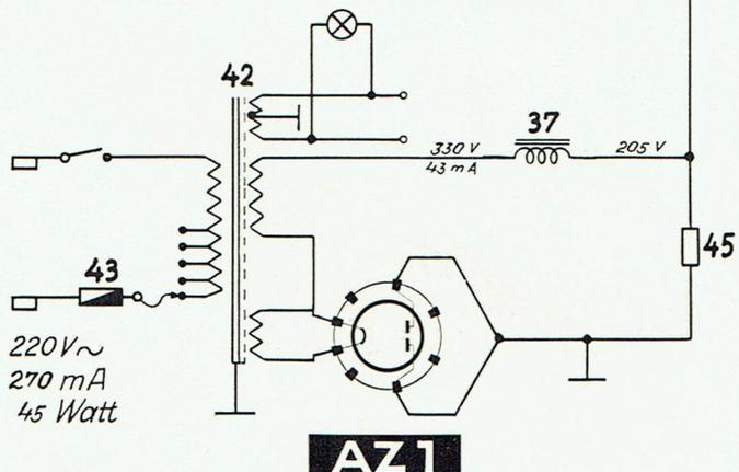
Alle Spannungen sind mit einem Spannungsmesser von 500  $\Omega$  je Volt (z. B. Siemens-T-Type, Gossen-Mavometer mit 500 Volt Einzel-Vorwiderstand usw.) gegen Masse gemessen.
