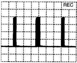
A: AC, 1 V/Div, 10us/Div IC 7004 PIN 37
