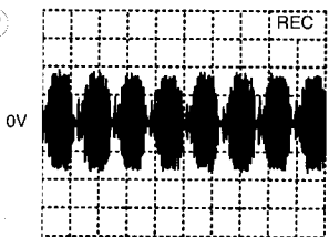
A: AC, 100mV/Div, 50us/Div IC 7004 Pin 50/48
