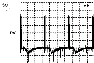
A: AC, 100mV/Div, 20us/Div IC 7804 Pin 32 B
