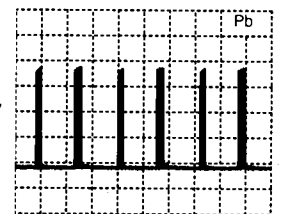
A: AC, 1 V/Div, 20us/Div IC 7004 Pin 37
