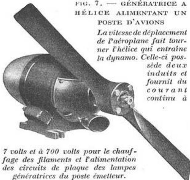
*7 volts et à 700 volts pour le chauffage des filaments et l'alimentation des circuits de plaque des lampes génératrices du poste émetteur.*
