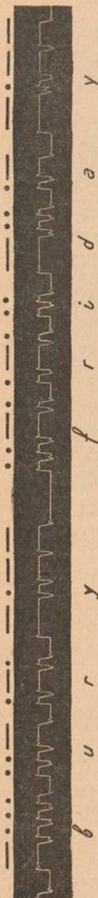
ENREGISTREMENT AU NOIR DE FUMÉE D'UN MESSAGE RADIOTÉLÉGRAPHIQUE ENVOYÉ D'ANGLETERRE ET REÇU SUR CADRE A PARIS
