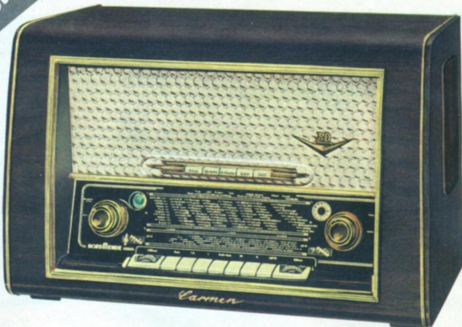
und 11 + 1 UKW-Kreise, Doppelvorkreisschaltung, 6-Watt-Endstufe, UKW, 3 gespreizte Kurzwellenbänder, Mittel- und Langwelle; Magisches Auge; Diskant- und Baßregler, Bandbreitenschalter, eingebaute UKW- und Ferrit-Peilantenne, 3 hochwertige Lautsprecher in 3D-Technik. **NORDMENDE-Carmen** ist auch ohne Klangregister lieferbar.
