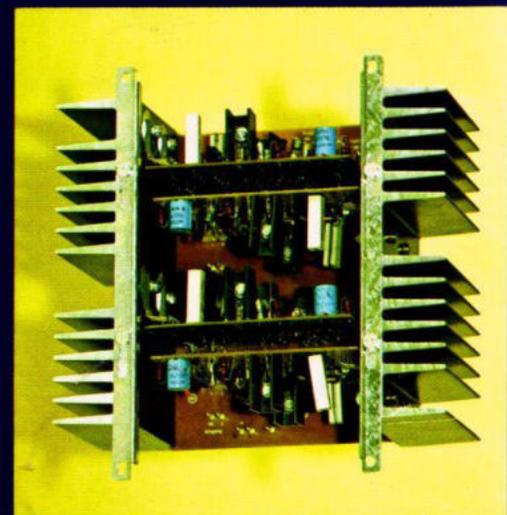
4 gleichspannungsgekoppelte Endstufen in Komplementärschaltung mit leerlauf- und kurzschlußsicheren Ausgängen.
