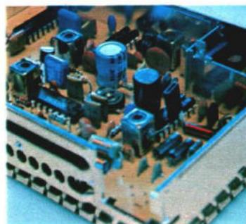
Farbfernseher. Das Bild stört also den Ton. Das völlig neue Quasi-Parallelton-Verfahren der ferngesteuerten Grundig 66-cm-Spitzenmodelle schließt solche Störungen jetzt aus. Bild- und Ton-Signale werden schon sehr frühzeitig getrennt, können sich daher nicht mehr gegenseitig stören und kommen so in optimaler Wiedergabequalität.
