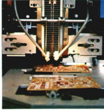
Absolut zuverlässig über einen Rechner stellt der Sequenzer, so heißt diese modernste Maschine. Bauelemente zusammen – genau in der Reihenfolge, wie sie später der Bestückungsautomat braucht.
