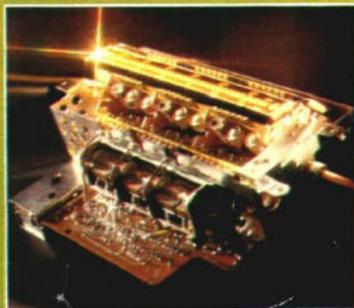
1. Ein hervorragendes Merkmal: Der KW-Trommeltuner
