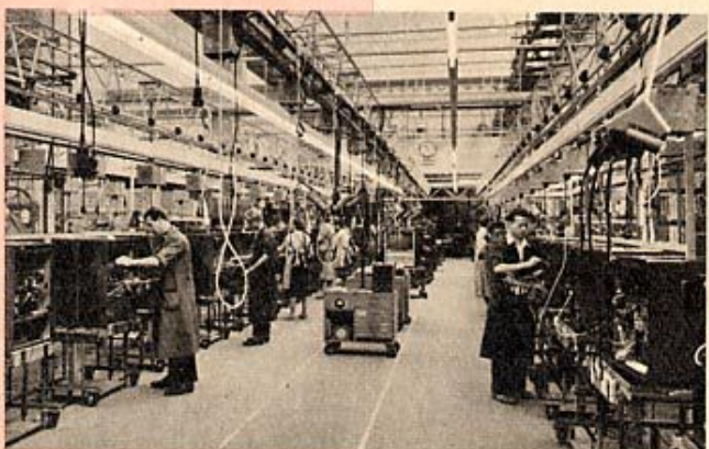
Die große Fertigungshalle für die Blaupunkt-Fernsehgeräte. Eine der modernsten Fertigungsstätten der Bundesrepublik in Fließbandtechnik.
