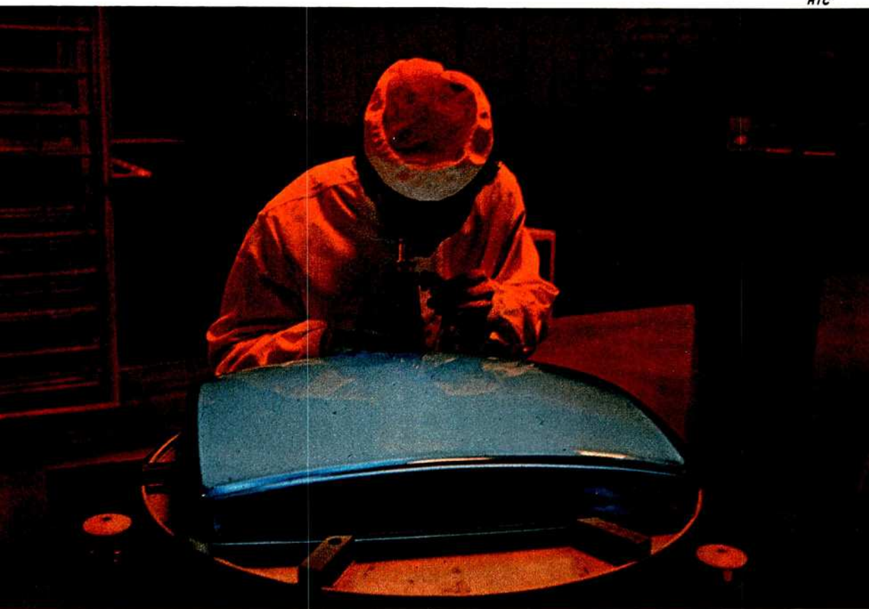
Contrôle du dépôt des luminophores (particules qui produisent les effets de couleurs) sur un écran de télévision.
