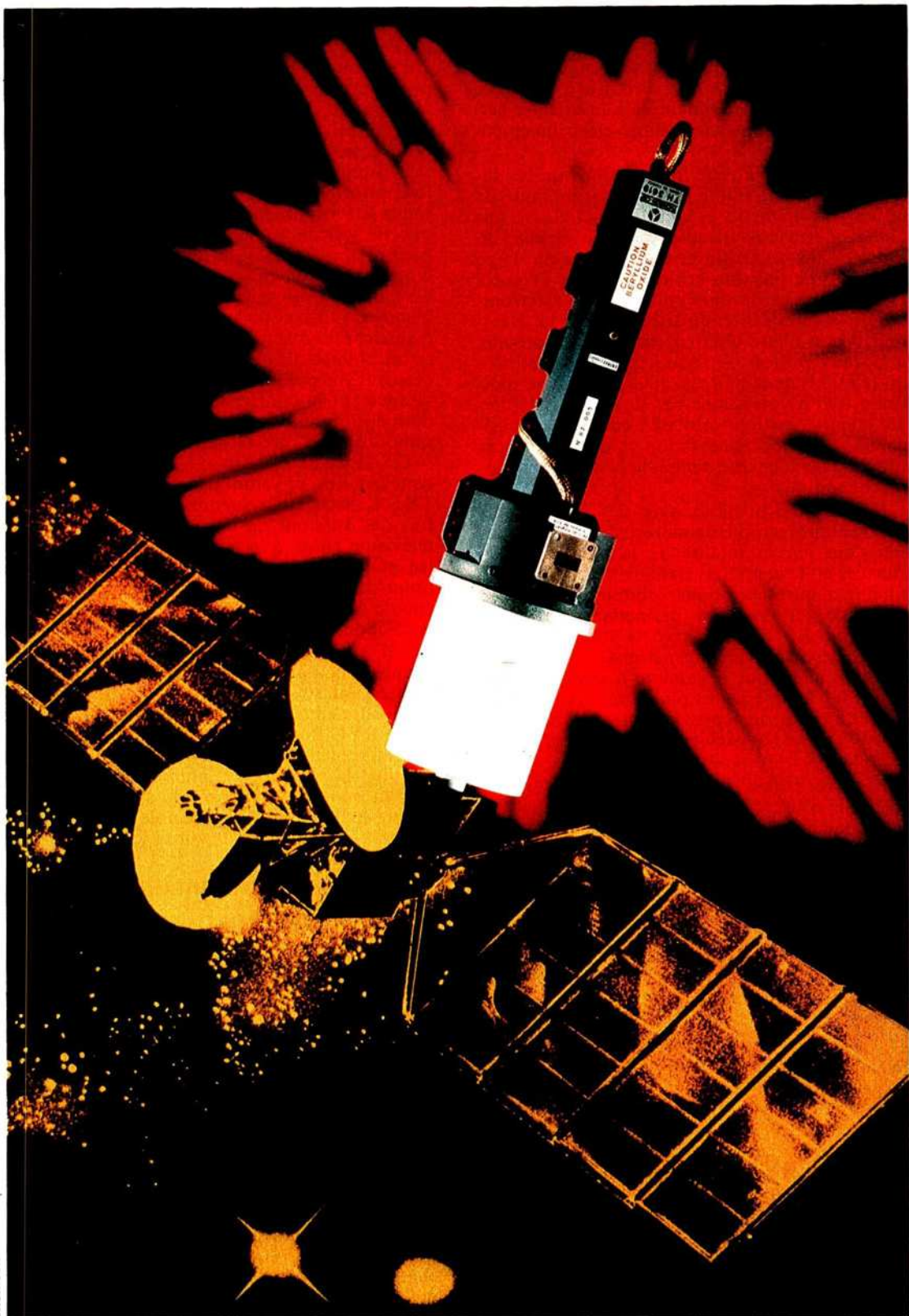
Les caractéristiques de réémission d'un satellite de télévision directe sont liées aux tubes à ondes progressives (au premier plan sur ce montage photographique) qui sont des amplificateurs de grande puissance.
