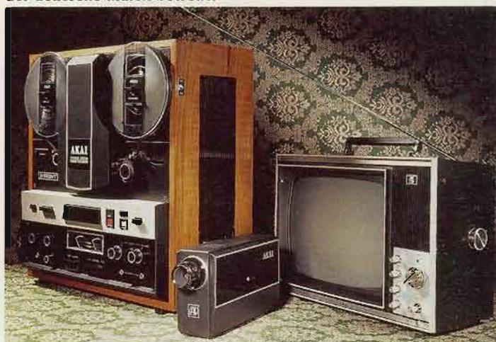
Anlage mit Kombinations-Tonband/Videorecorder X-500 VT
