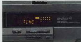
**TIME:** Mit dieser Funktion sorgt der CD-Player von Anfang an dafür, daß eine Programmfolge zusammengestellt wird, die der Länge einer Cassettenseite möglichst nahekommt, diese aber nicht überschreitet.
