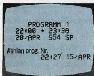
Erster Videorecorder mit Timerprogrammierung über Fernbedienung. Dies ist die logische Weiterentwicklung des Bildschirmdialogs: Auf dem Bildschirm erscheint ein Formular, das sie einfach per Fernbedienung ausfüllen.
