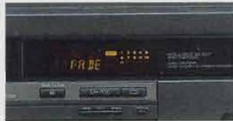
**FADE:** Abgeschnittene Stücke am Ende eines Bandes sind unschön. Deshalb wird mit dieser Funktion am Ende einer Cassettenseite automatisch kurz ausgeblendet (fade: ca. 1 Sekunde), das auf diese Weise vorzeitig abgebrochene Stück wird auf der zweiten Cassettenseite noch einmal ganz aufgezeichnet.
