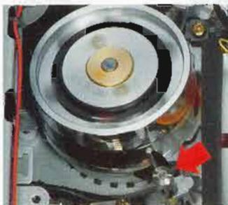
Erster Videorecorder mit Quickstart-Laufwerk. Dieses Laufwerk macht Schluß mit einer Kinderkrankheit des VHS-Systems: Bei jedem Stop-Befehl das Band wieder auszufädeln. Dadurch vergehen bis zu acht Sekunden, bis nach Betätigen der Start-Taste tatsächlich ein Bild auf dem Bildschirm erscheint. Das Akai-„Full-Loading“-Laufwerk bleibt einfach ständig eingefädelt, die Reaktionszeit wird damit verkürzt auf weniger als eine Sekunde!
