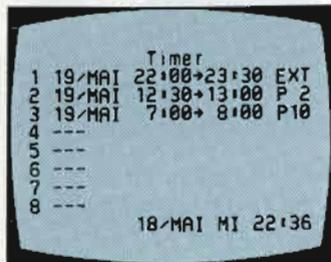
Erster Videorecorder mit Bildschirm-Dialogsystem; Dieses System nutzt den großen TV-Bildschirm als Display für sämtliche Funktionen
