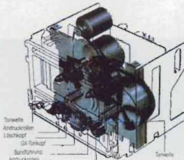
Beim Doppel-Capstan-Antrieb (Capstan = Tonwelle) sorgen je 2 Tonwellen vor und hinter dem Tonkopf für einen gleichmäßigen Bandtransport. Die beiden Tonwellen werden direkt angetrieben, der Anker des Motors dient zur Erhöhung der Massenträgheit. Beide Motoren sind in einem geschlossenen Regelkreis ver-
