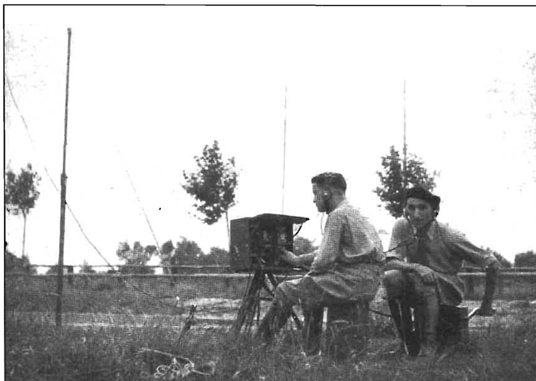
Fig. 4. — L'ER-12 en action. Le deuxième opérateur est assis sur la machine à main. (coll. A. Salles - photo origine inconnue)
