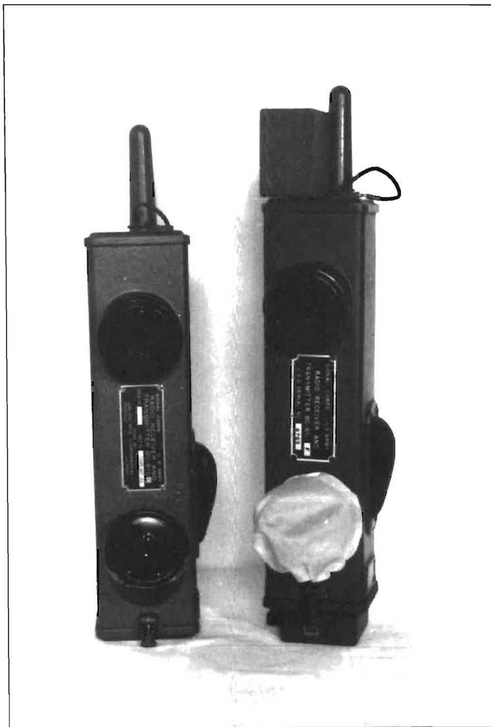
Fig. 6. — BC-611-C (à gauche) et BC-611-F avec BC-1387 (à droite)
