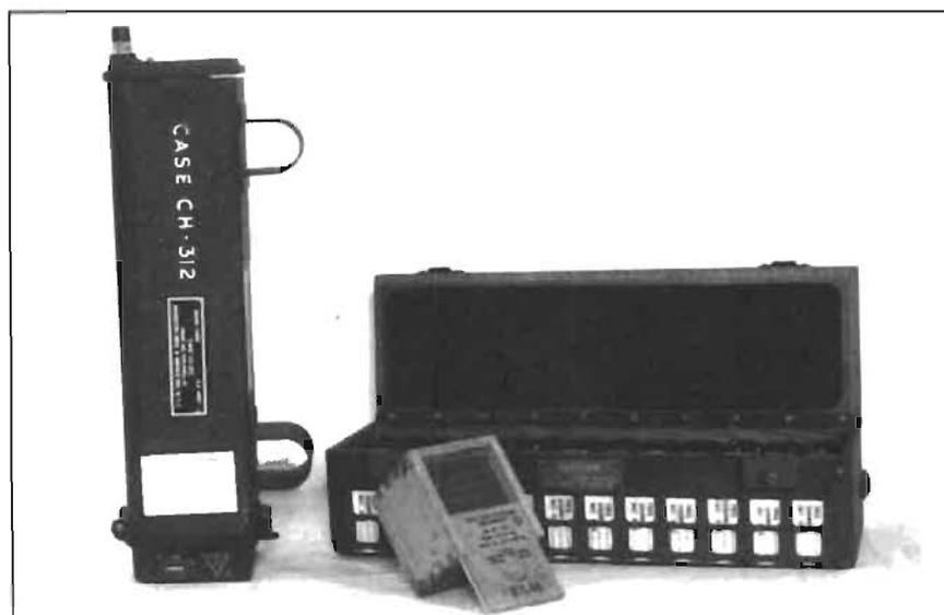
tensions BF de sortie et l'activité des quartz. Il intègre un générateur HF modulé utilisé pour l'alignement du récepteur et un générateur BF pour déterminer le taux de modulation. (fig. 10)
