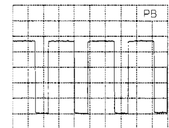
A: DC, 1 V/Div, 10us/Div IC 7410 Pin 31
