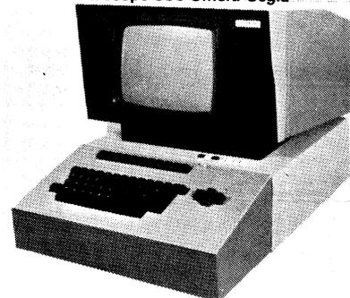
clavier : le Datascope 800. Un à quinze de ces terminaux peuvent être organisés en réseau étoilé autour d'un contrôleur, lui-même relié à un ordinateur central. Les terminaux peuvent communiquer entre eux ou avec des télé-imprimeurs reliés au concentrateur. L'ensemble Datascope 800 est constitué des éléments de base suivants :
