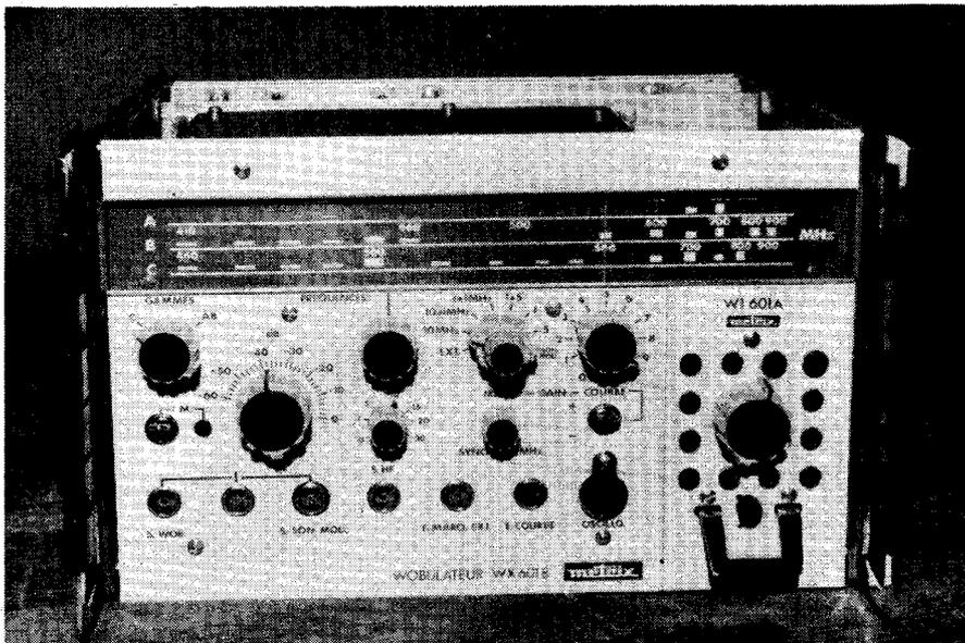
Pour le réglage visuel des circuits H.F. et F.I. des téléviseurs et des récepteurs FM, dans les bandes de fréquences allant d'une fraction de mégahertz à 960 MHz.
