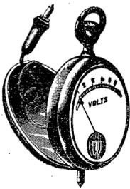
Voltmètres et Ampèremètres de poche forme montre électromagnétiques, avec fils conducteurs logés à l'intérieur du boîtier.
