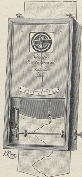
Le galvanomètre est à cadre mobile, il est très robuste. Le cadre est muni de deux index, l'un en avant, pour la lecture sur un cadran divisé, l'autre en arrière, pour porter la plume de l'enregistreur.
