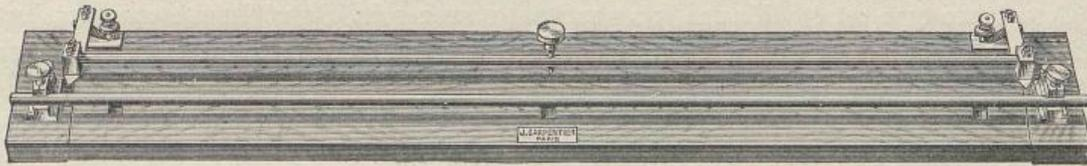
Cet appareil est le complément du pont précédent, dans le cas où les conducteurs à mesurer sont des tiges droites ; il permet de prendre toujours rigoureusement la même longueur (généralement 1 mètre), et de déterminer, bien exactement, les points entre lesquels la résistance est comptée.
