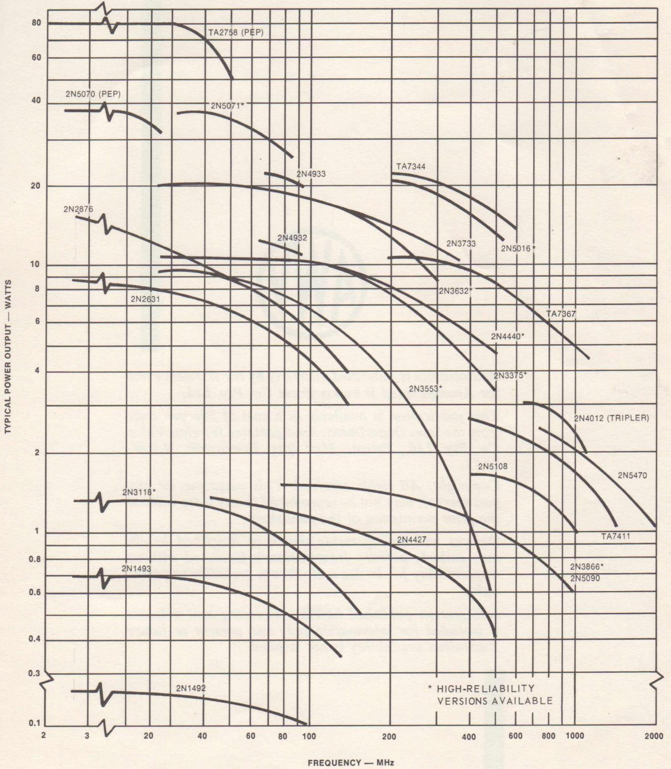
FIG. 23. - R.F. POWER TRANSISTOR SELECTION CHART.
