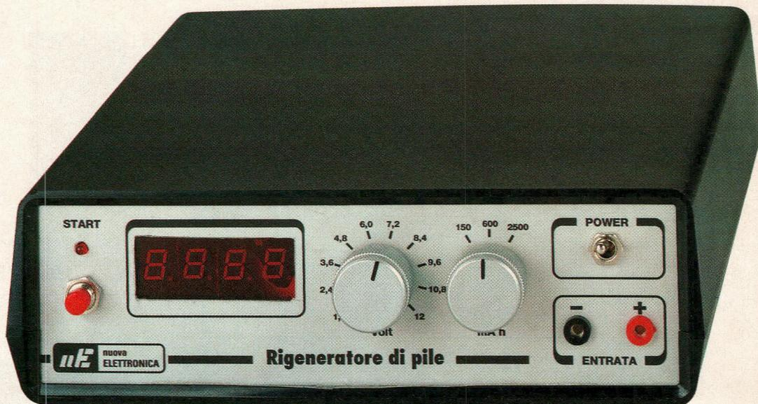
A noter qu'à chaque fois qu'un accu est mis en place, il faut appuyer sur le poussoir P1. L'affichage se réinitialise alors automatiquement (voir patte 13 de IC5) et le compteur repart à nouveau de "0000".
