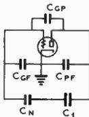
EQUIVALENT ULTRA-AUDION PARASITIC CIRCUIT
