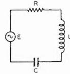
FIG. 2 - SERIES CIRCUIT
